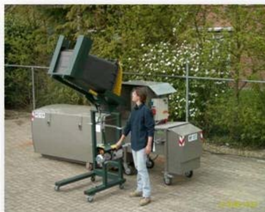
MSP 700 avec installation de levage pour bacs à ordures.
