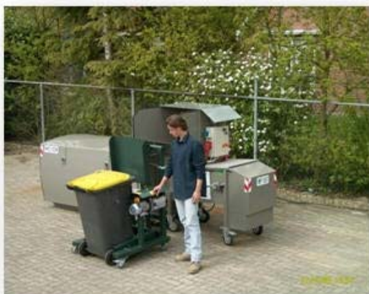
MSP 700 avec installation de levage pour bacs à ordures.
